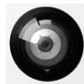
Kamera 80 Farvekamera med juster- bar vidvinkelobjektiv, kan justeres mekanisk.
