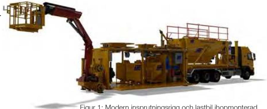
Figur 1: Modern insprutningsrigg och lastbil ihopmonterad för lagring av fogmassa. Med tillstånd av AMV Norge.
